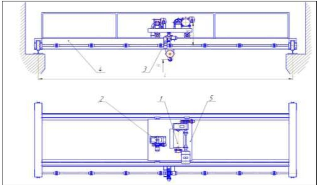
1 – Механизм подъема груза; 2 – Механизм передвижения грузовой тележки; 3 – Механизм передвижения моста; 4 – Балка; 5 – Грузовая платформа
